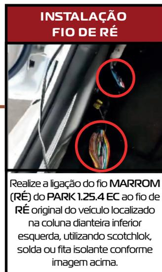
Realize a ligação do fio **MARROM** (RÉ) do **PARK 1.25.4 EC** ao fio de **RÉ** original do veículo localizado na coluna dianteira inferior esquerda, utilizando scotchlok, solda ou fita isolante conforme imagem acima.
