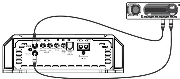
Exemplo da conexão com um RCA utilizando a saída para ligar um segundo amplificador.
