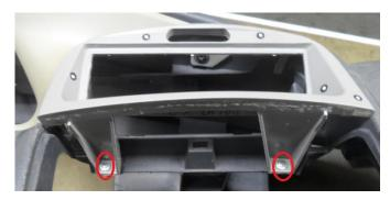
3 – Instale na Moldura Fiamon os fixadores D e E com 04 Parafusos panela Philips 2,9 X 9,5 mm.
