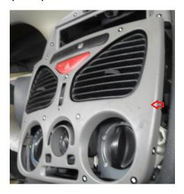
2- Retire os parafusos e a moldura superior.
