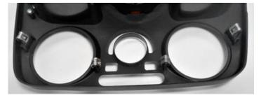
5 – Instale o pisca alerta com 04 - Parafusos panela Philips 2,9 X 16 mm.
