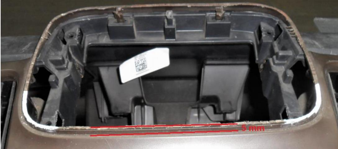
2 - Demarque com uma fita adesiva para ajudar a visualização, efetuar o corte com auxílio de uma serrinha e alicate de corte bem afiado.
