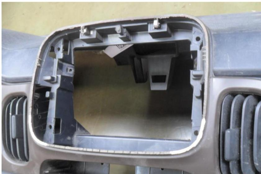
**3 – Após finalizar o recorte, instale o aparelho na moldura e faça a instalação, certificando que fique bem encaixada a moldura no ponto de fixação.**
